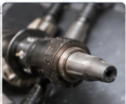
NOxセンサーの損傷・劣化
